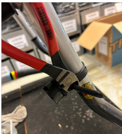
⑦ Klipp av den overfløydige lengden på stroppen med en kabelkutter eller kniv.
