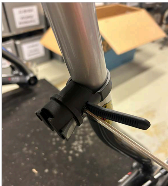
⑥ Stram skruen/stroppen med 4 mm unbrakonøkkeln til stroppen er stram.
